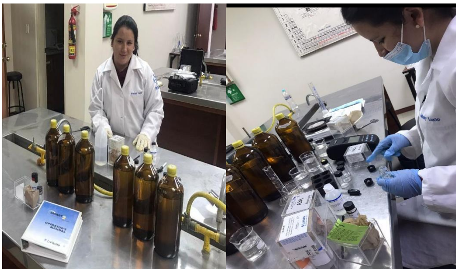
Determinación de nitritos, nitratos, amonio y fosfatos con el equipo colorímetro LAMMOTTE
