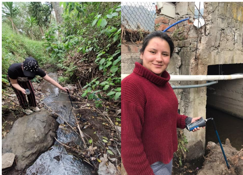
Manejo de molinete para la determinación de la velocidad del afluente
