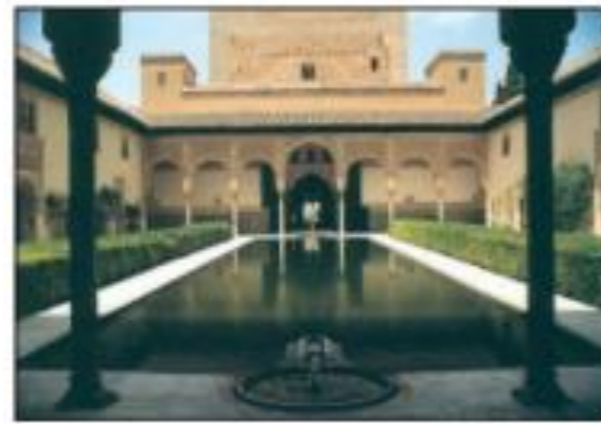
Figura 13: Vivienda árabe con espejo de agua en el patio central como forma de mantener la vivienda fresca en respuesta a las altas temperaturas de verano.
