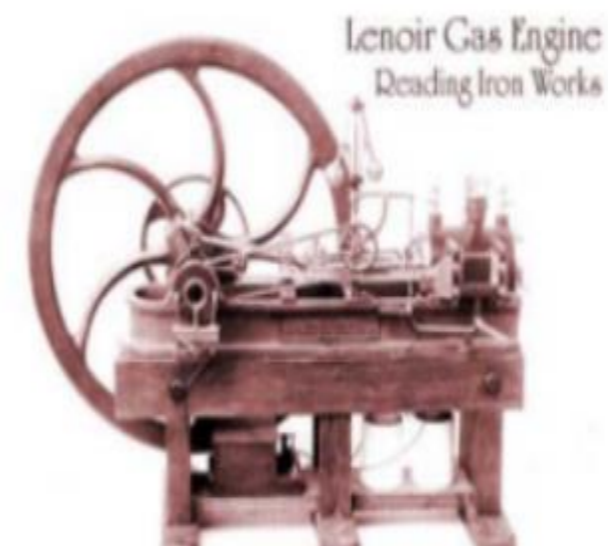
Figura 16: Ilustración de un Motor de combustión interna construido y patentado por Jean Lenoir, 1859. Fuente: Tomado de https://bit.ly/3FjKcTf
