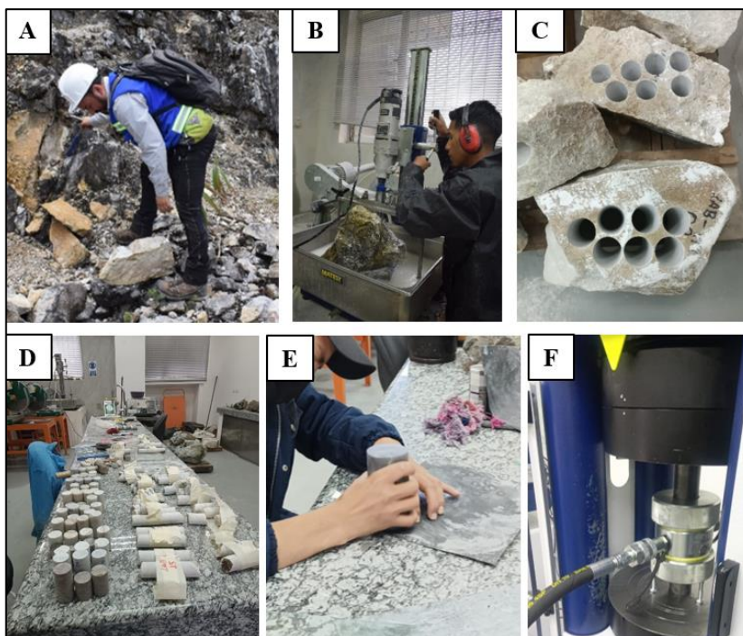
Figura 7. Preparación de muestras y ejecución del ensayo triaxial. A) Muestreo, B) Perforación de muestras, C) Evidencia de extracción de probetas de 37 mm de diámetro. D) Tripleta de testigos por cada muestra, E) Lijado de bases de la probeta, F) Ejecución de ensayo triaxial mediante Celda Hoek.
