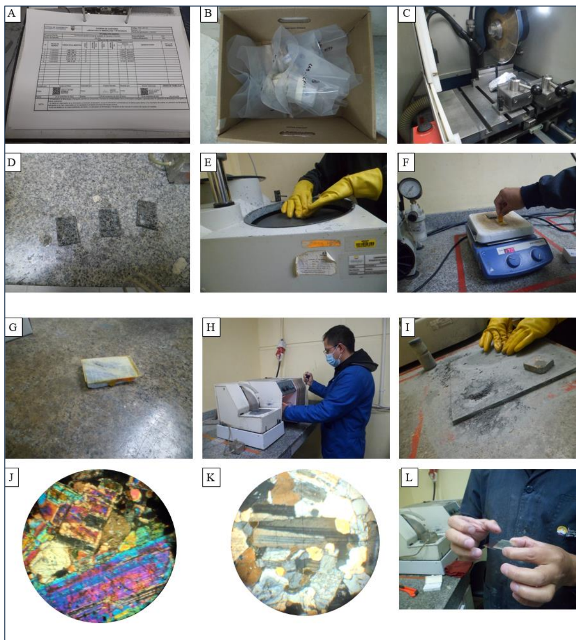
Figura 11. Esquema para la elaboración de una lámina delgada. A) Cadena de custodia para el ingreso de las muestras al laboratorio, B) Almacenamiento muestras en fundas plásticas codificadas, C) Corte grueso de la muestra, D) Obtención de prisma regular de muestra, E) Se observa cómo se pule una cara del prisma para dejarla lisa y plana, F) Calentamiento de la resina termoplástica a una temperatura de 130°C, G) Pegado de la muestra al portaobjetos, mediante la goma termoplástica, H) Pulido de precisión, hasta obtener una sección muy lisa, I) Lijado final de la superficie con abrasivo #1000, J) Revisión de las propiedades ópticas de los minerales, se observa colores de birrefringencia altos para minerales como cuarzo, por lo que es necesario continuar el proceso de devaste, K) Propiedades ópticas de los minerales marcadores (cuarzo, plagioclasa, feldespatos) en correcto orden, L) Colocación del cubre objetos para preservar la muestra adecuadamente.
