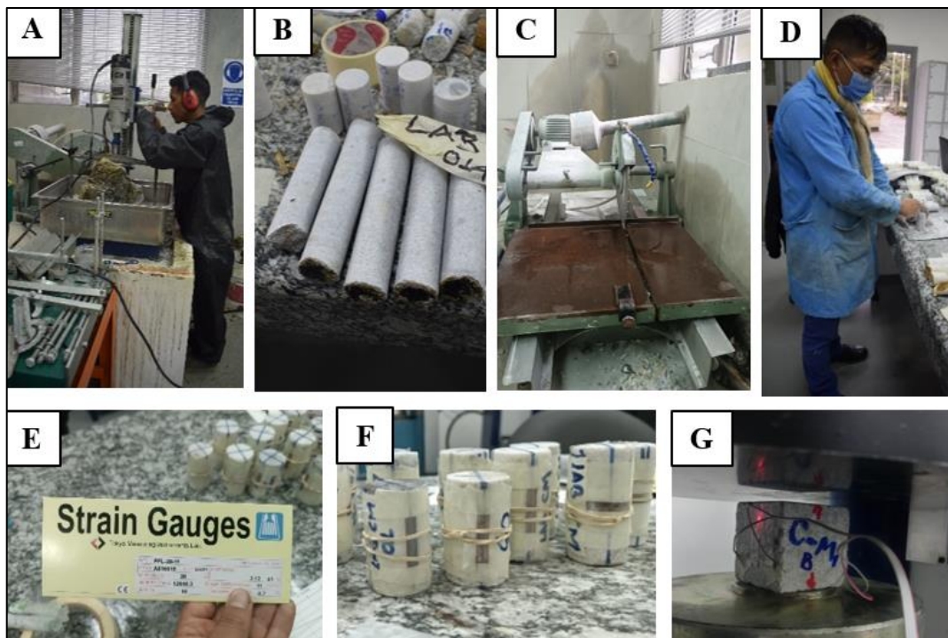
Figura 8. Preparación de muestras y ejecución del ensayo de compresión simple con módulos de elasticidad. A) Perforación de probetas de 37 mm, B) Testigos de diferentes longitudes, C) Equipo de corte, D) Lijado de las bases del testigo con el fin de mantener el paralelismo entre las caras. E) Juego de Strain Gauges con factor de galga de 120 \pm 1 [ohmios ( \Omega )], longitud de 20 mm. F) Pegado de galgas extensométricas en el eje axial y radial. D) Ejecución del ensayo de compresión simple con medición de la deformación (axial y radial) con el fin de calcular las constantes elásticas.
