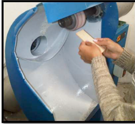
Ilustración 5.19 : Gráfico Pulimiento de triplex
