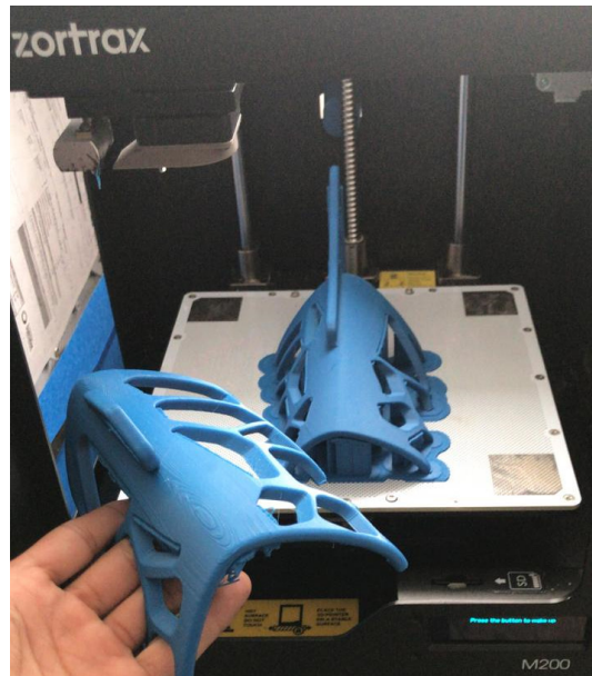
Figura 4.19. Fabricación en impresión 3D del rehabilitador de codo.
