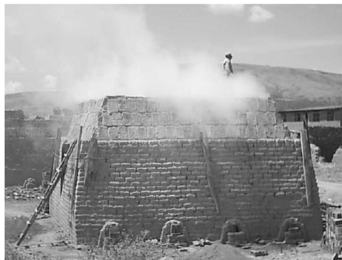
Figura 19. Horno tradicional para cocción de ladrillos tipo volcán, (Luján & Guzmán, 2015)
