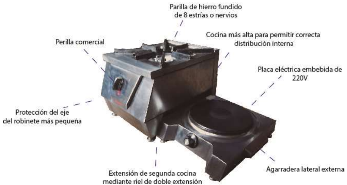
Imagen 26: Elementos y partes del prototipo. Elaboración: Andrés Mejía
