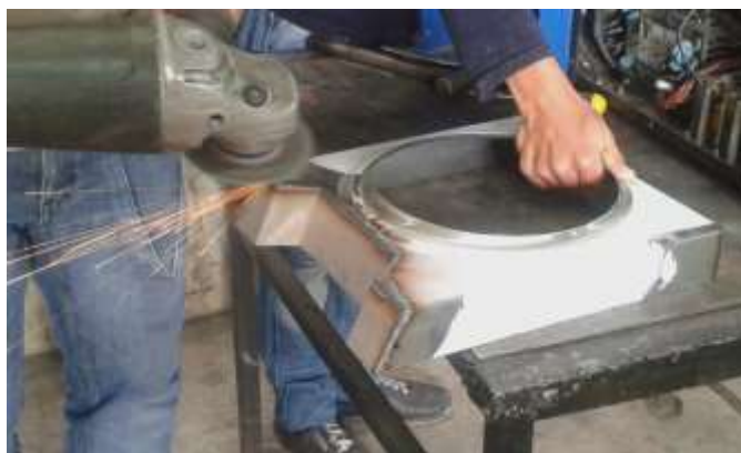
Imagen 39: Proceso de fabricación cuerpo del módulo eléctrico. Elaboración: Andrés Mejía.
