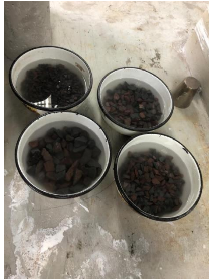
Figura 2.15. Humedecimiento de agregado grueso para ablandar terrones de arcilla.
