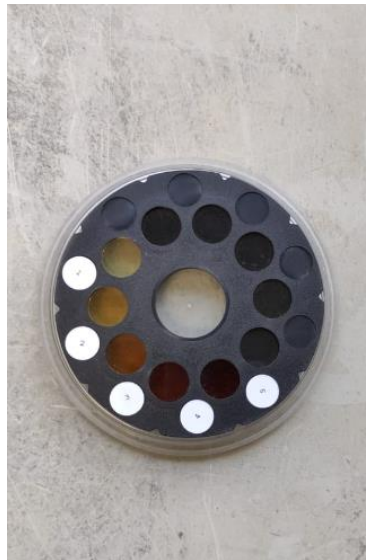
Figura 2.18. Disco de colores normalizado para determinar el contenido orgánico.
