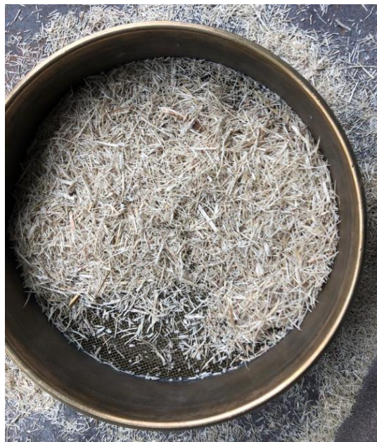
Figura 2.35. Proceso de tamizaje del bagazo de caña por el tamiz número 16.
