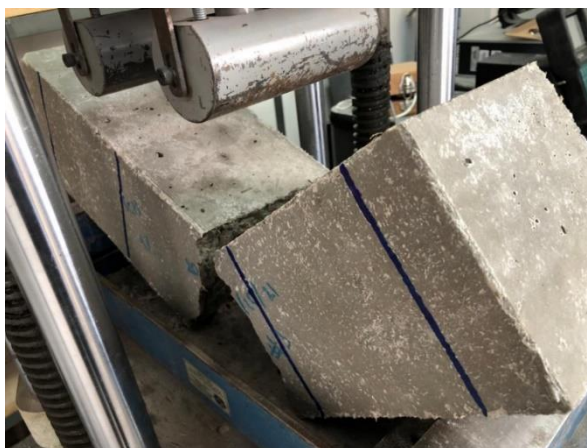
Figura 2.45. Falla producida en el tercio medio de la viga.
