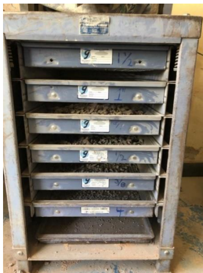
Figura 2.4. Serie de tamices y tamizadora mecánica para agregado grueso.
