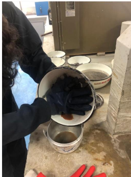
Figura 2.20. Remoción de sulfato a muestra de agregado.
