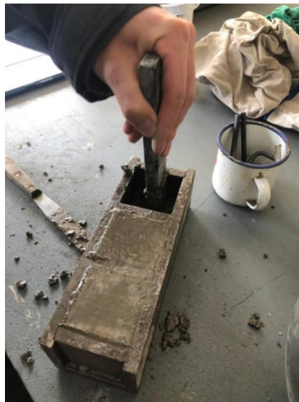
Figura 2.30. Colocación de mortero fresco en molde cúbico.
