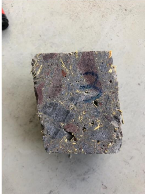
Figura 2.39. Distribución del 3% de fibra de bagazo de caña respecto al peso del cemento en el hormigón.
