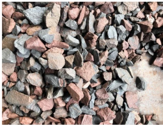
Figura 2.12. Muestra agregado grueso saturado con superficie seca.
