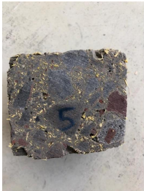
Figura 2.40. Distribución del 5% de fibra de bagazo de caña respecto al peso del cemento en el hormigón.
