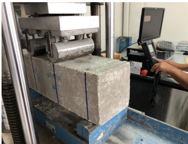
Figura 2.44. Ensayo de resistencia a flexión en vigas.
