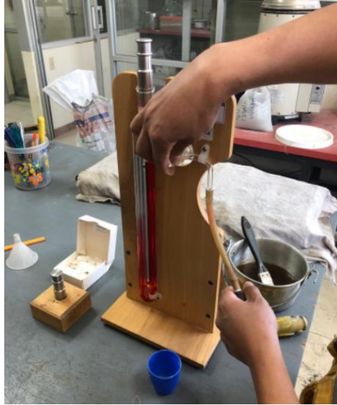
Figura 2.26. Ensayo de finura del cemento por el método Blaine.
