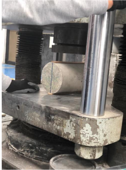
Figura 2.47. Ensayo de tracción indirecta, método brasilero.
