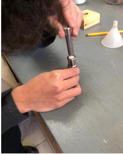
Figura 2.24. Colocación de papel filtro en celda de permeabilidad mediante un émbolo.
