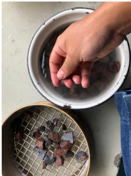
Figura 2.16. Remoción de terrones de arcilla con yemas de los dedos.
