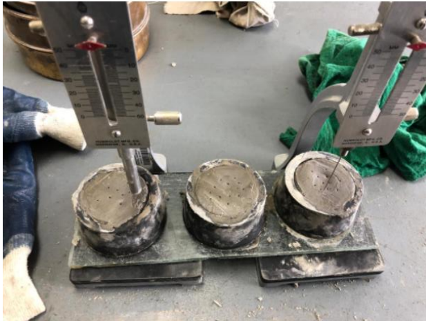
Figura 2.27. Ensayo de tiempo de fraguado por el método de Vicat.
