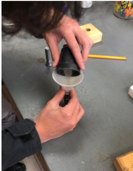
Figura 2.25. Colocación de muestra de cemento en celda de permeabilidad.
