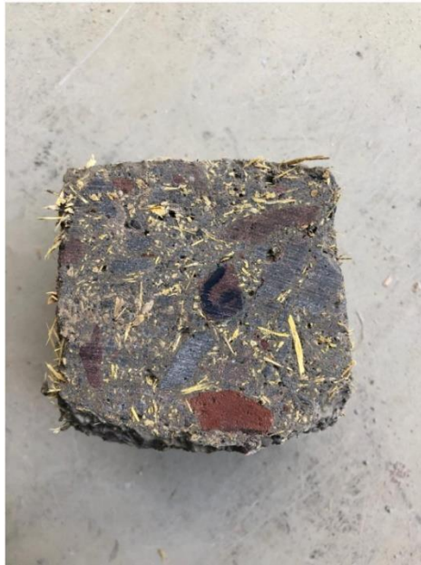
Figura 2.41. Distribución del 6% de fibra de bagazo de caña respecto al peso del cemento en el hormigón.
