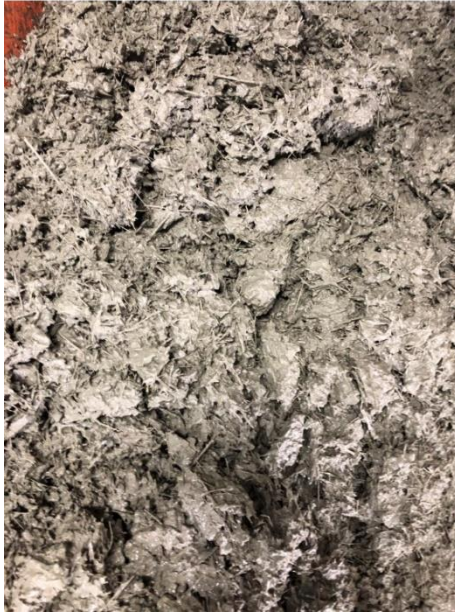
Figura 2.37. Mezcla fresca de hormigón con fibras de bagazo de caña.
