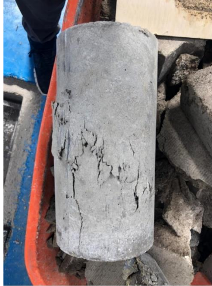
Figura 2.43. Falla en el cilindro de hormigón después del ensayo de compresión simple.
