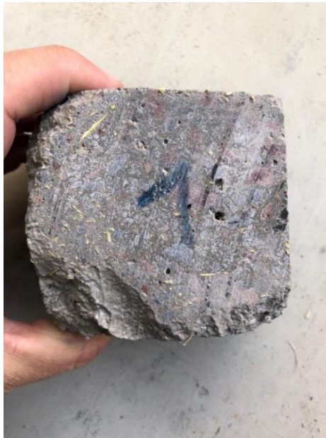
Figura 2.38. Distribución del 1% de fibra de bagazo de caña respecto al peso del cemento en el hormigón.
