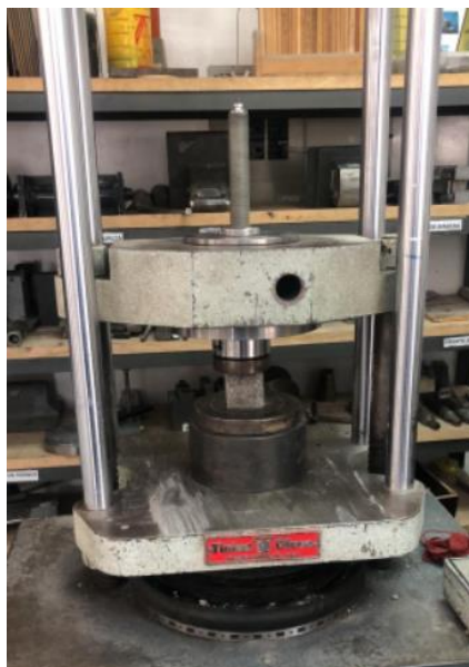
Figura 2.31. Compresión de mortero de cemento.
