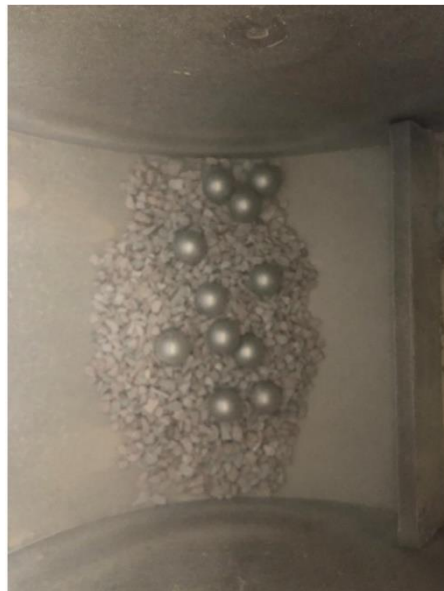
Figura 2.22. Muestra de agregado grueso con rulimanes dentro de la máquina de los ángeles.
