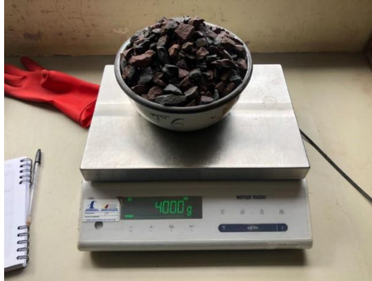
Figura 2.11. Muestra de agregado grueso saturado.
