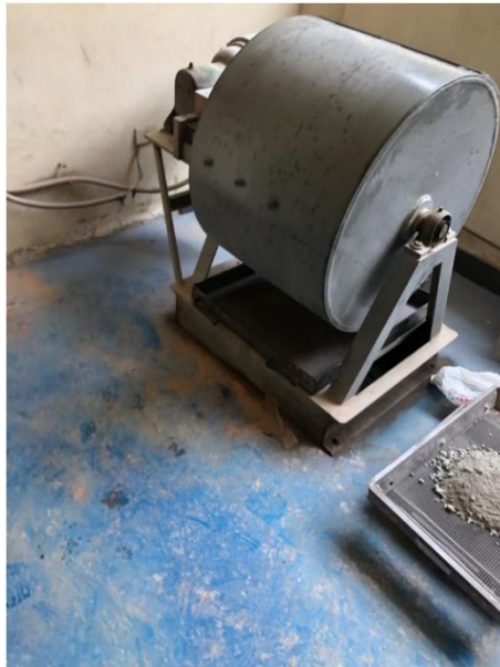
Figura 2.21. Máquina de tambor rotatoria para ensayo de desgaste de agregado grueso.
