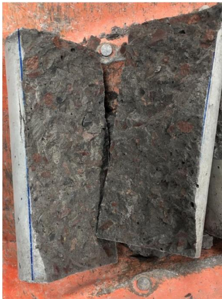
Figura 2.48. Falla producida en el cilindro de hormigón por el ensayo de tracción indirecta.
