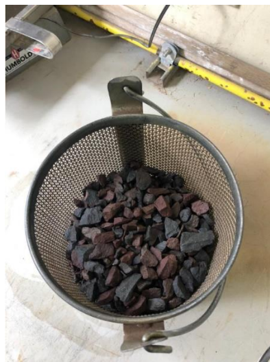
Figura 2.13. Canastilla para tomar peso sumergido de agregado grueso.
