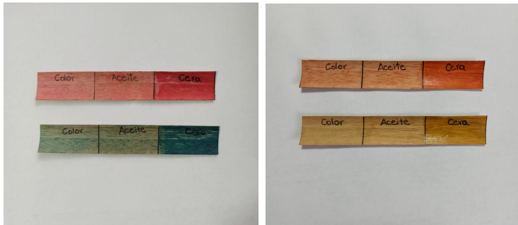
Figura 70. Comparación de muestras tras proceso de lavado. (Elaboración Propia)
