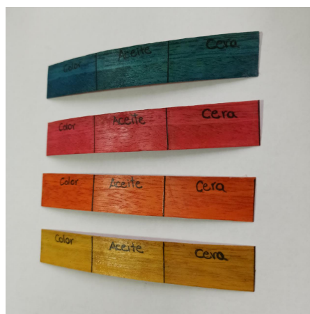
Figura 69. Muestras en chapa tras aplicación de colorante y acabados. (Elaboración Propia)
