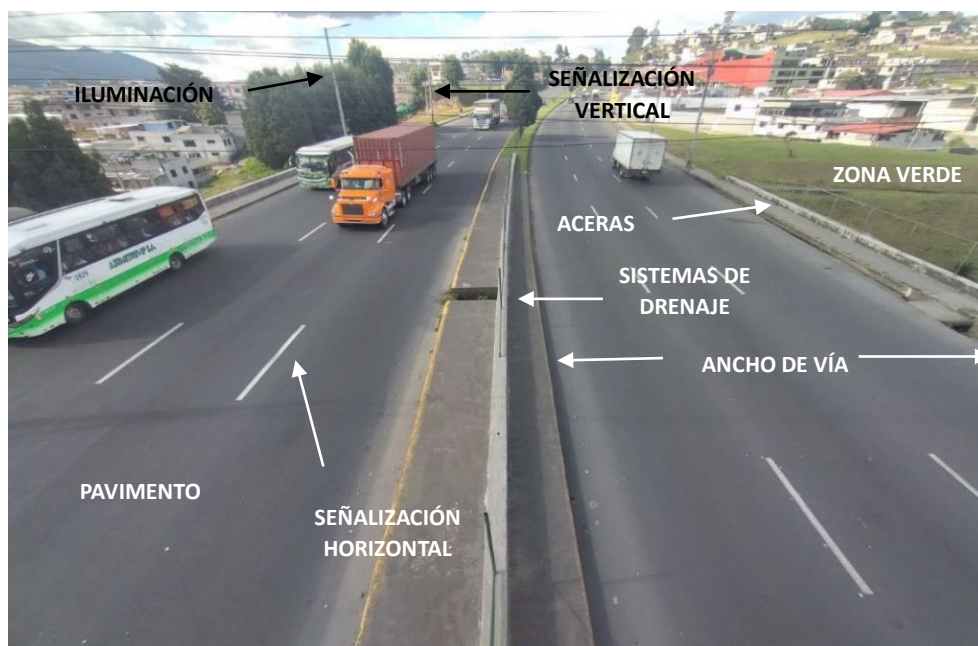
Figura 3. Elementos de una vía Fuente: (Elaboración Propia)
