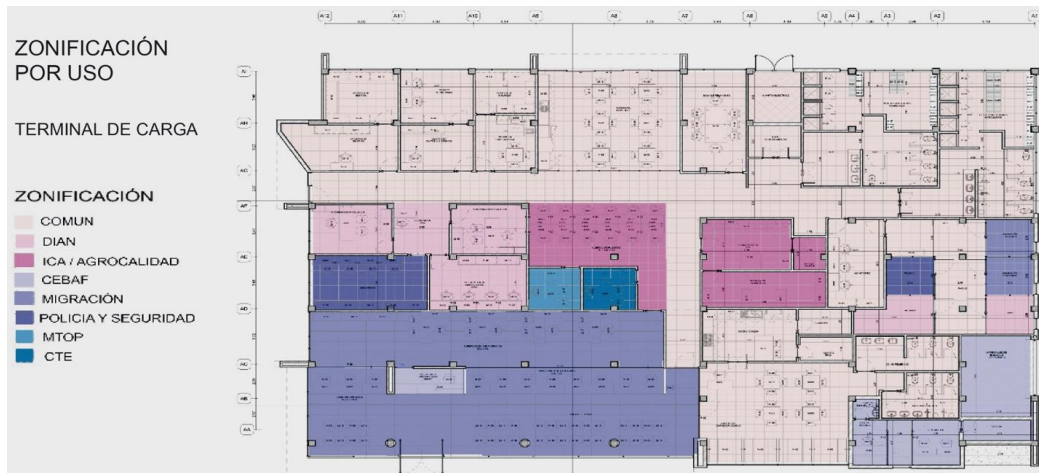
Figura 2. Zonificación por uso del terminal aduanero de carga en el CEBAF de Ecuador
