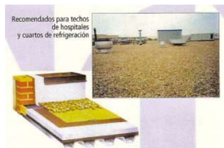
IMAGEN 7 Diagrama de impermeabilización
