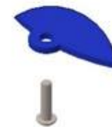
Detalle B SCALE 1 : 1 Ajuste Mecánico - Atornillado
