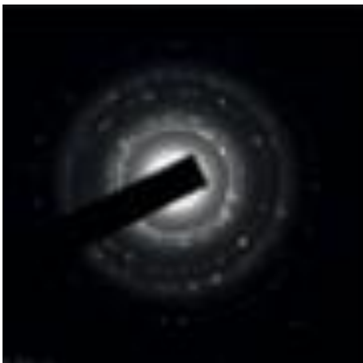
Figura 6. Imagen SAED de AgNPs sintetizadas por reducción química (Agnihotri et al., 2014)
