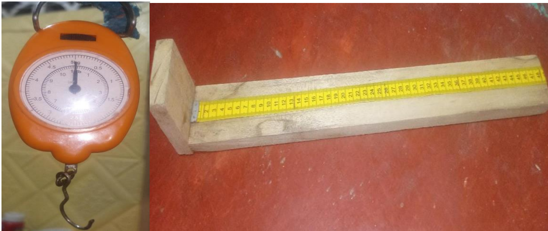
Figura 2. Ictiómetro y balanza utilizada para las tallas y peso de los pulpos
