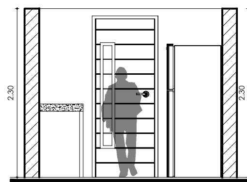
CORTE A-A' - PUESTO TIPO 2 DE CARNES ROJAS, CARNES BLANCAS, EMBUTIDOS, LÁCTEOS, PESCADOS Y MARISCOS ESC: 1:50
