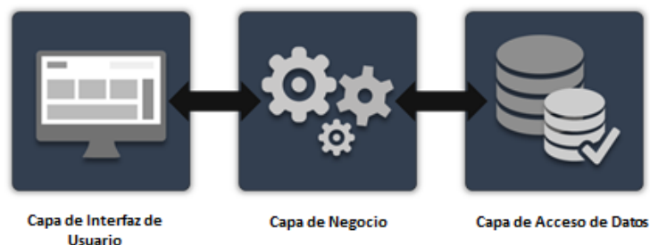
Ilustración 3: Interacción de un programa con arquitectura de tres capas, 2017
