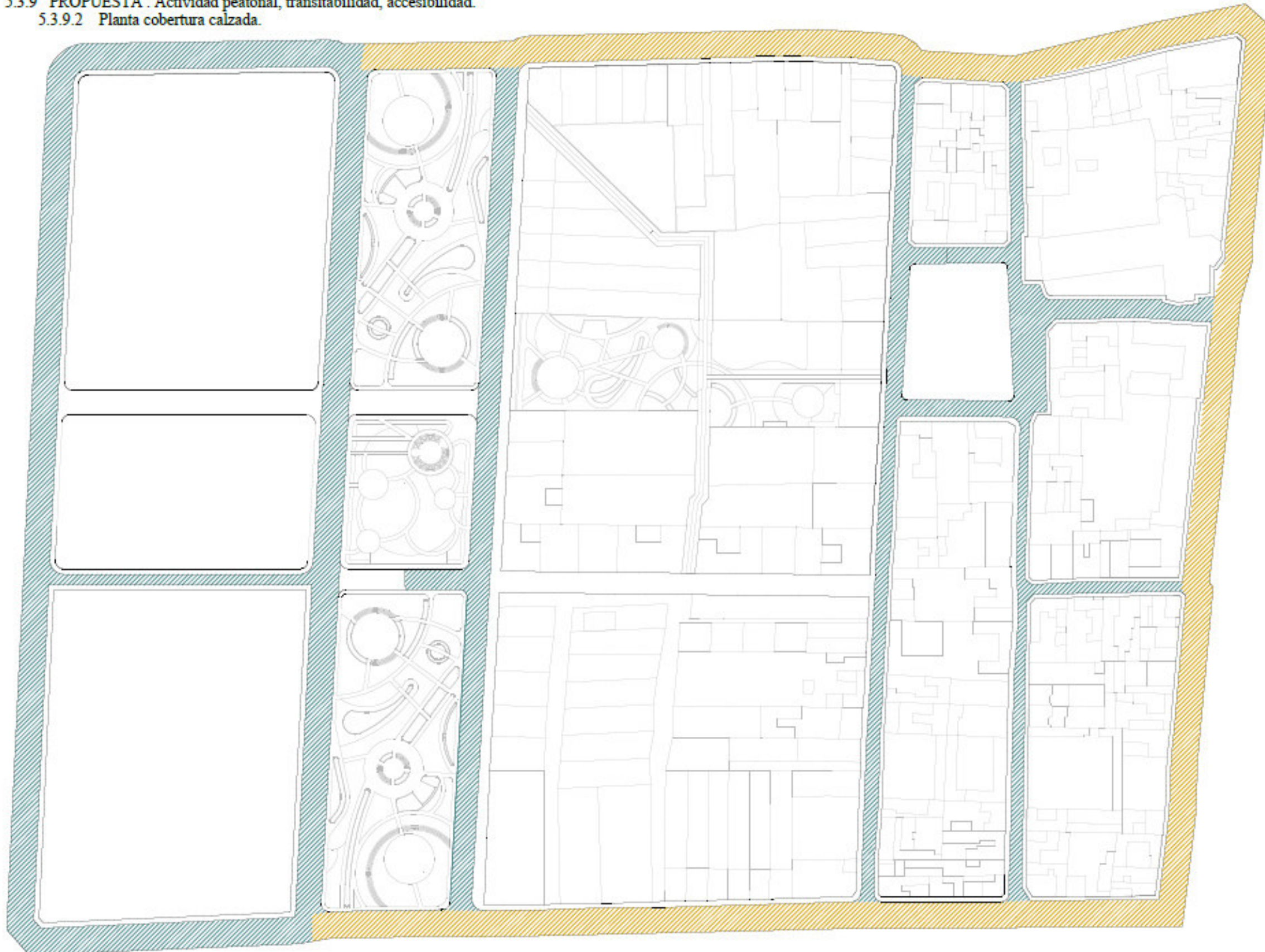
PLANTA CAPA DE RODADURA CALZADA ESCALA 1:1000
