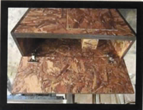
Imagen 53 Instalación de herrajes Fuente: Virginia Rampón Rosero, 02 de mayo de 2012.
