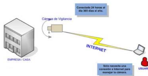
Figura 2.4: Sistemas de Vigilancia mediante cámaras IP
