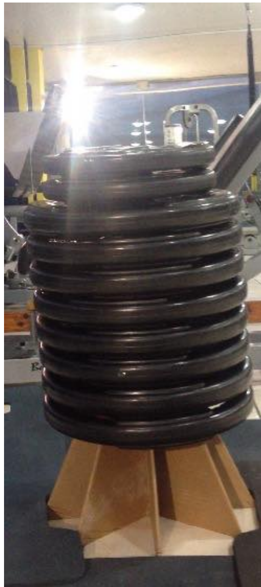
Ilustración 4.164. Prueba de carga máxima en prototipo
