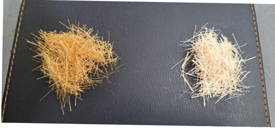
Ilustración 9: izq.) Fibra tratada 2% NaOH. der.) Fibra sin tratar. Fuente: Elaboración Propia
