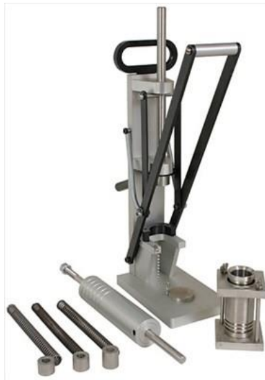
Ilustración 11: Equipo Harvard Miniatura. Fuente: Geotechpedia
