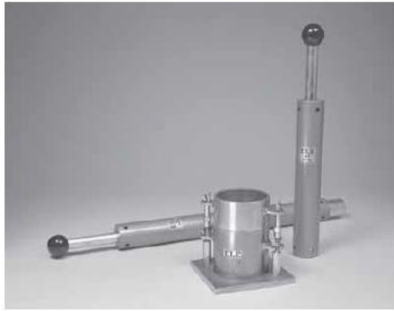
Ilustración 10: Equipo Proctor Estándar. Fuente: Das, 2015
