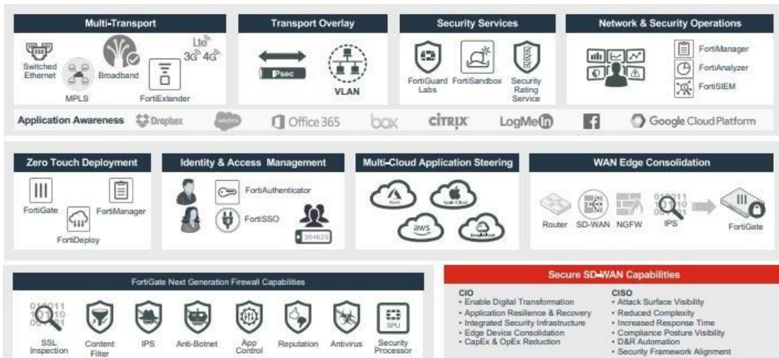
Figura 6 Componentes de SD-WAN de Fortinet [27].
