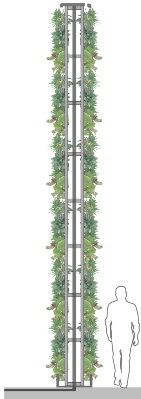
CORTE LONGITUDINAL MURO VERDE
