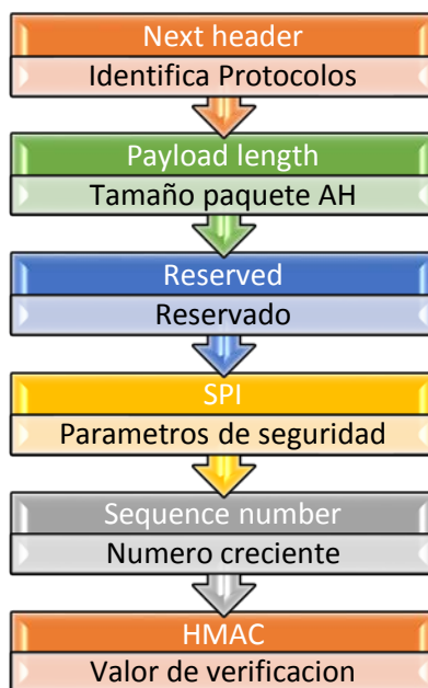
Ilustración 25: Campos de la Cabecera de Autenticación, (Aguas Bucheli, 2014)
