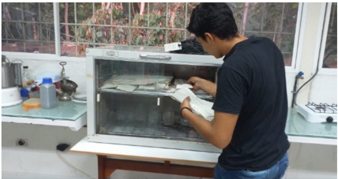
Figura 16: Muestras pesadas y sometidas a la estufa
