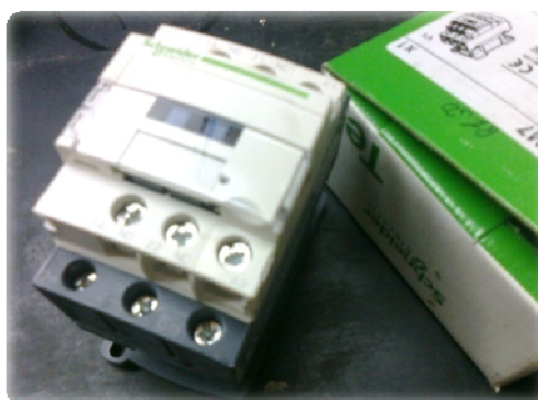
Imagen 24: Caja de contactor Telemecanique
