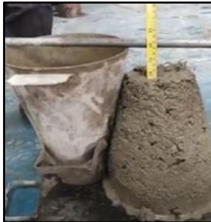
Imagen 4. 2 Prueba de asentamiento
