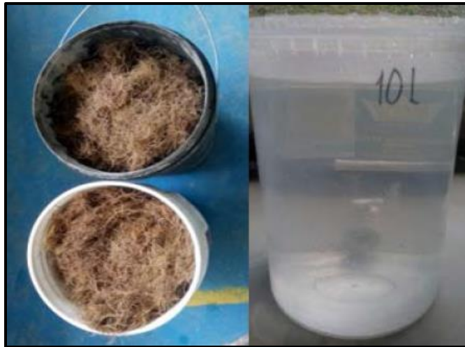
Imagen 3. 6 Proceso de ensayo de la densidad en la fibra
