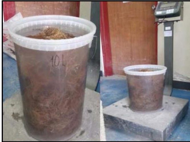
Imagen 3. 7Proceso de ensayo de la densidad en la fibra.
