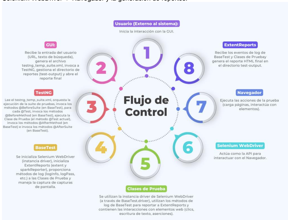
Figura 2. Diagrama de bloques que muestre GUI -> TestNG -> BaseTest -> Clases de Prueba -> Selenium WebDriver -> Navegador y la generación de reportes.
