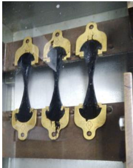
Fotografía N° IV.8 Ensayo de ductilidad
