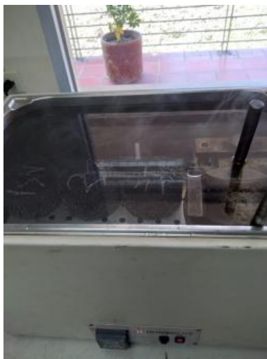
Fotografía N° V.4 Baño maría a 60°C para ensayo Marshall
