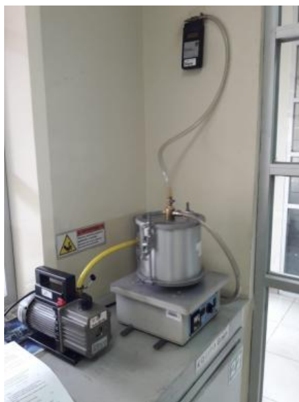
Fotografía N° V.5 Extractor de vacíos ensayo RICE
