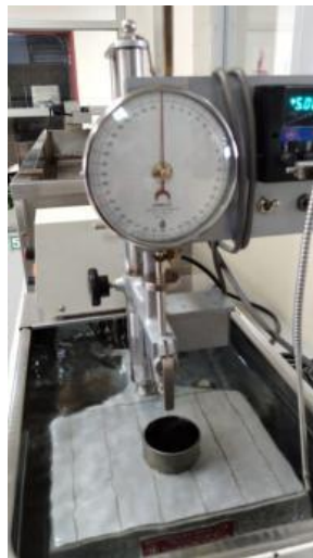
Fotografía N° IV.5 Máquina de penetración
