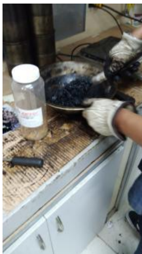
Fotografía N° V.7 Mezcla asfáltica con aditivo Súrfax TB-1
