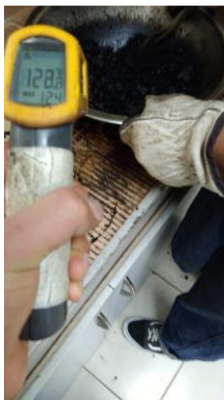
Fotografía N° V.10 Mezcla asfáltica tibia a 120°C
