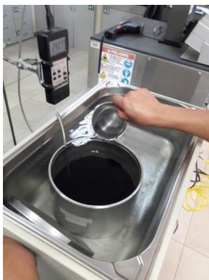
Fotografía N° V.6 Llenado de agua al contenedor, ensayo RICE
