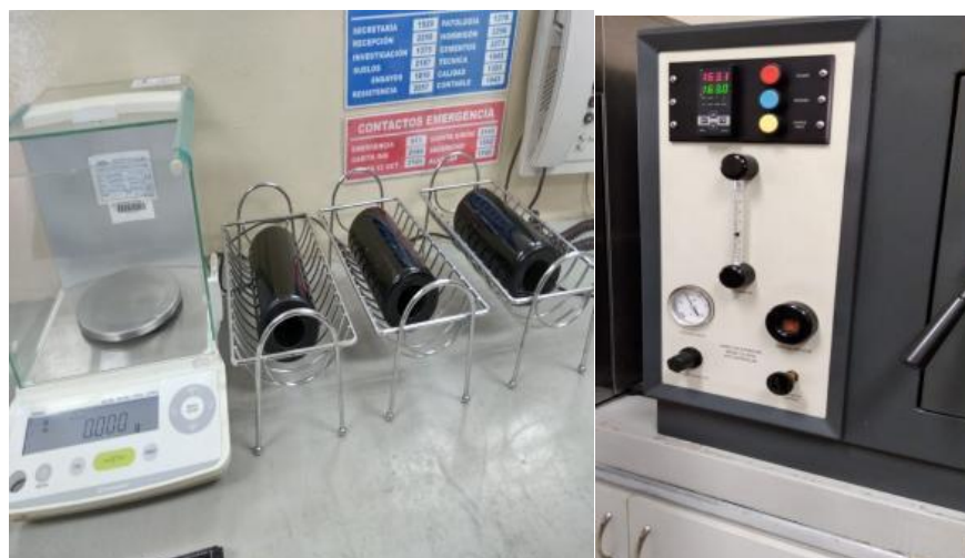
Fotografía N° IV.7 Contenedores y horno para determinar cambio de masa
