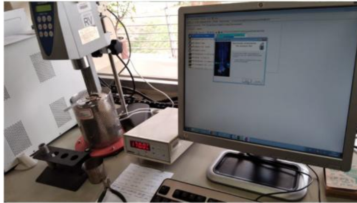
Fotografía N° IV.2 Viscosímetro para varias temperaturas
