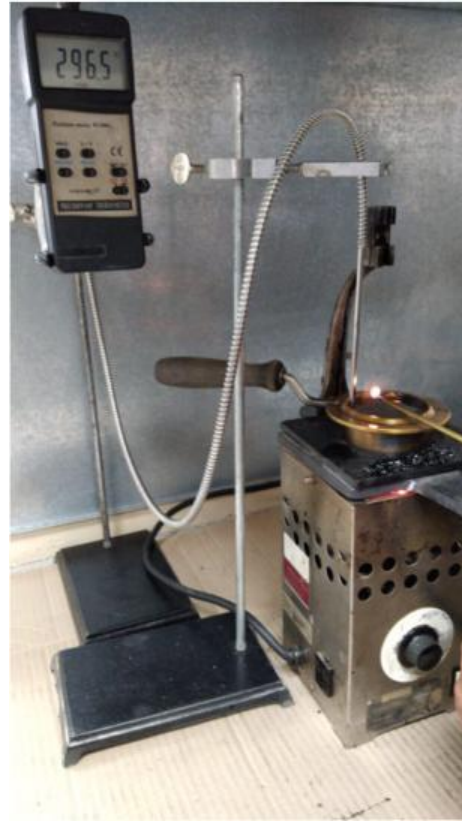
Fotografía N° IV.3 Ensayo copa Cleveland
