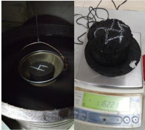
Fotografía N° V.3 Peso de muestras sumergido y en seco
