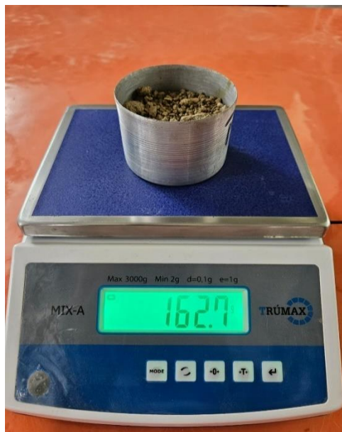
Muestra seca para determinación de capacidad de campo
