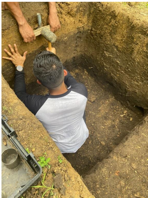
Obtención de muestras cilíndricas en perfiles del suelo
