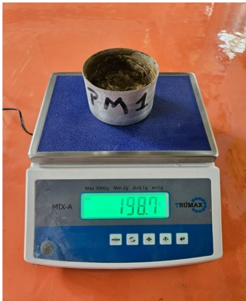
Muestra húmeda para determinación de capacidad de campo
