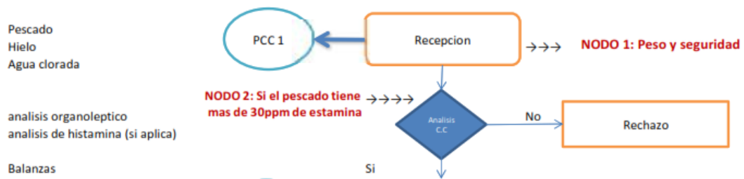
Figura 7.- Esquema del área de recepción de productos
