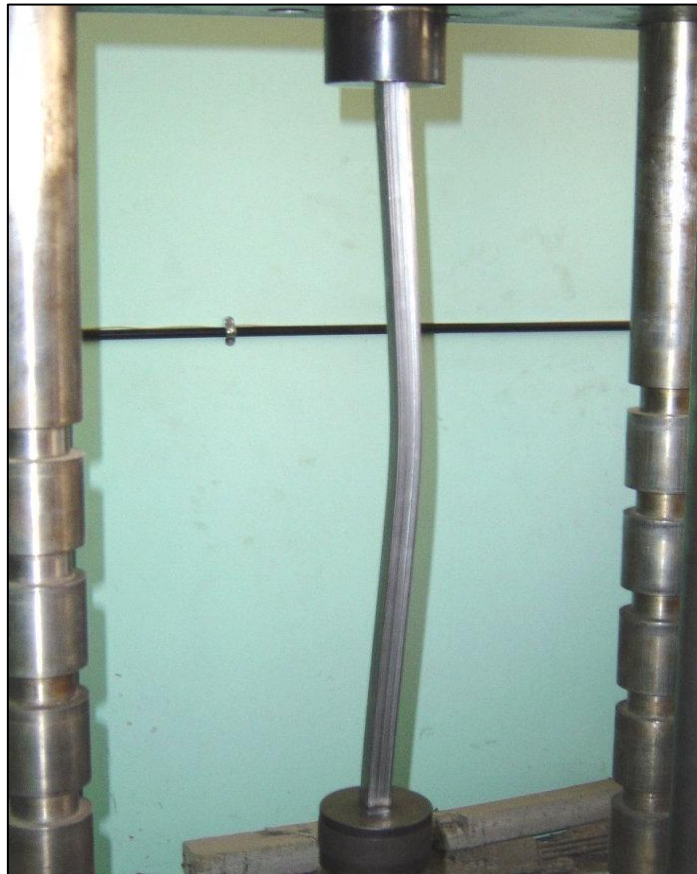
Figura 1.- Simulación en laboratorio del fenómeno de pandeo en columnas.
