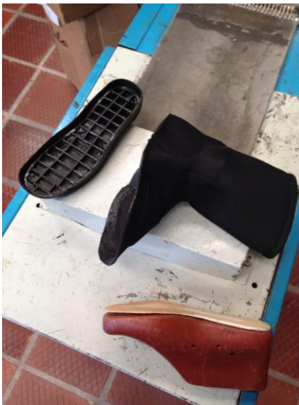
Gráfico N 4.21: Montaje en horma
