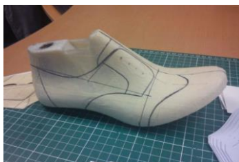
Gráfico N 2.21: Diseño en Horma
