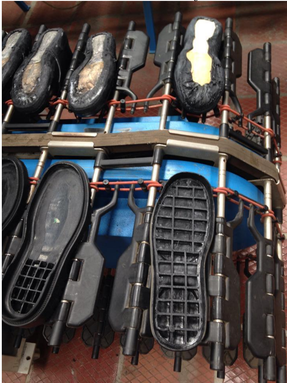
Gráfico N 11: Reactivación de Pegantes
