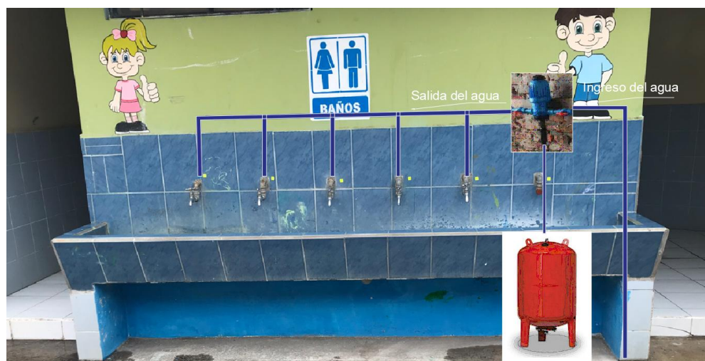
Figura 45. Esquema de la instalación del dosificador proporcional en el bloque 1. Fuente: autoría propia
