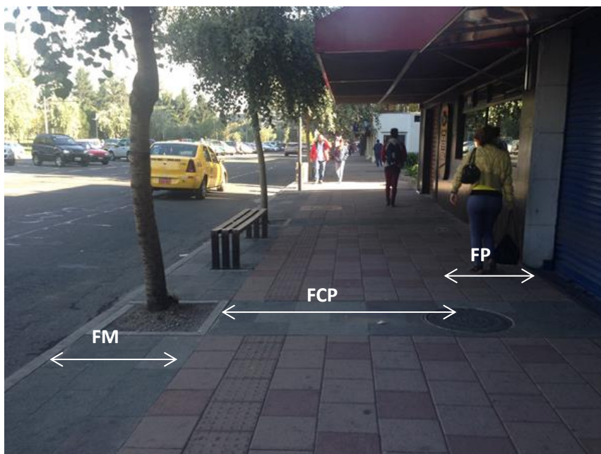
Figura 4.2. Franjas de la vereda - Av. Shyris
