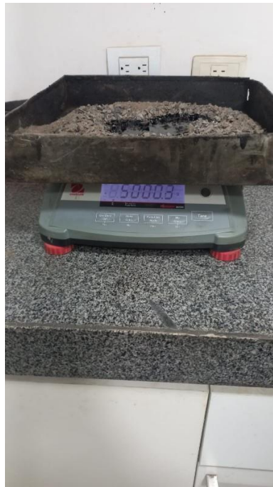
Ilustración 10. Preparación de muestras previo a la colocación de emulsión asfáltica
