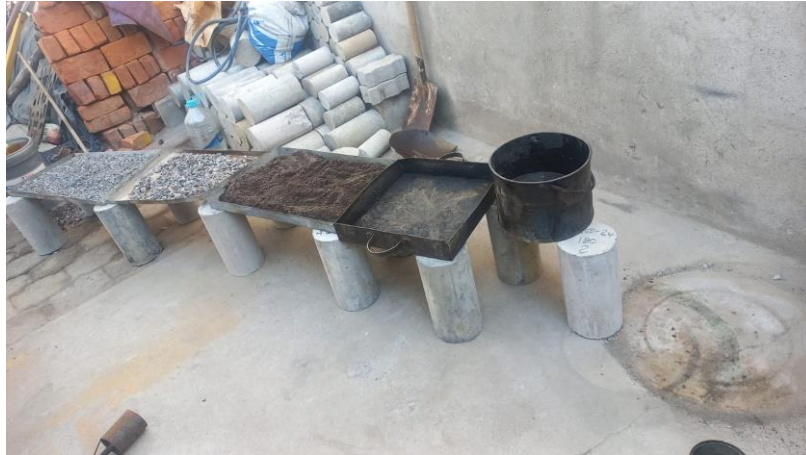
Ilustración 8. Agregados para mezcla asfáltica
