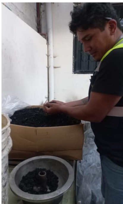
Ilustración 17. Selección del RAP para realizar la extracción del asfalto
