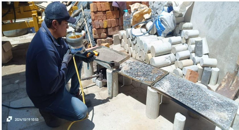
Ilustración 9. Calentado de agregados para mezcla asfáltica
