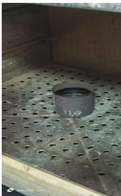
Ilustración 21. Gasolina extraída del lavado del RAP
