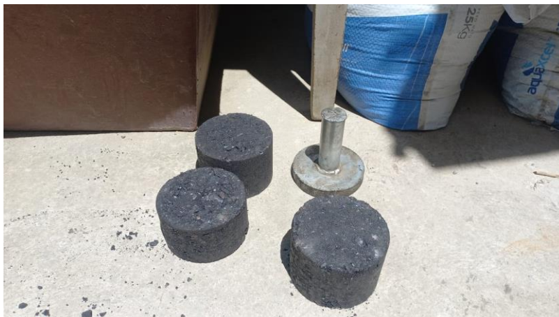
Ilustración 14. Normativa 75 golpes por cada lado de la briqueta
