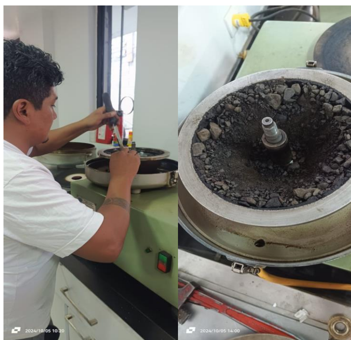
Ilustración 19. Resolver el material con ayuda de espátula
