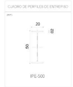
CUADRO DE SECCIONES EN ENTREPISO Escala 1:25
