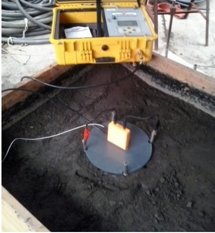
Gráfico 11 - Medición con Densímetro Eléctrico.
