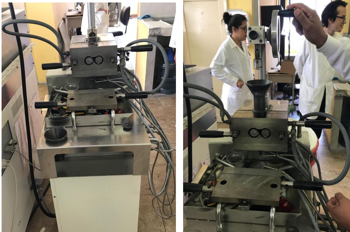
Reómetro utilizado para realizar el mezclado de PET con ácido adípico a diferentes proporciones de los mismos y con distintos tiempo.
