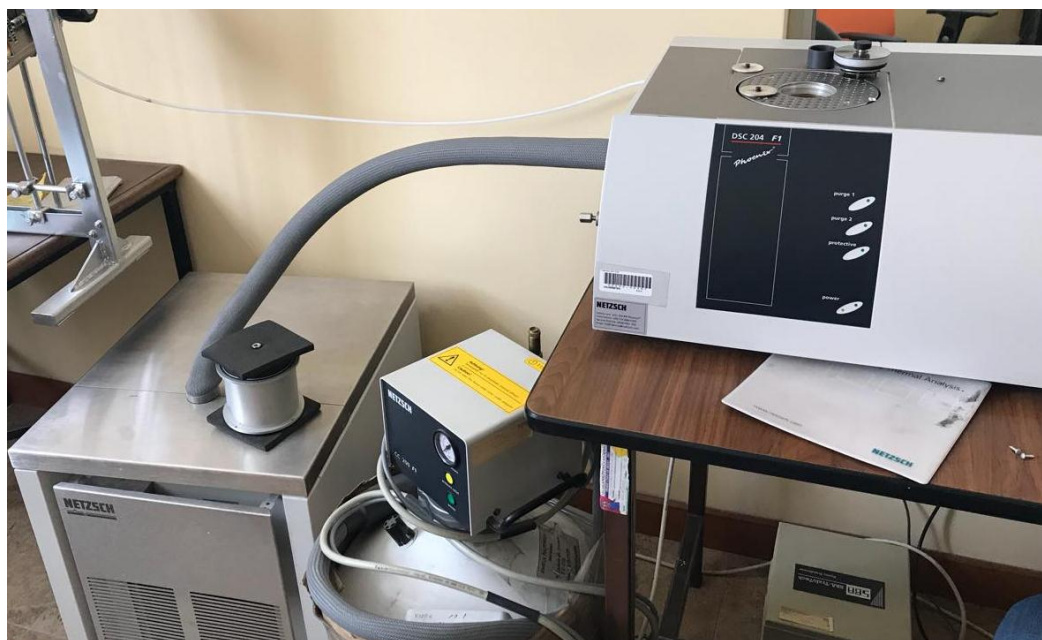
Caracterización del producto de la depolimerización del PET mediante calorimetría diferencial de barrido (DSC)
