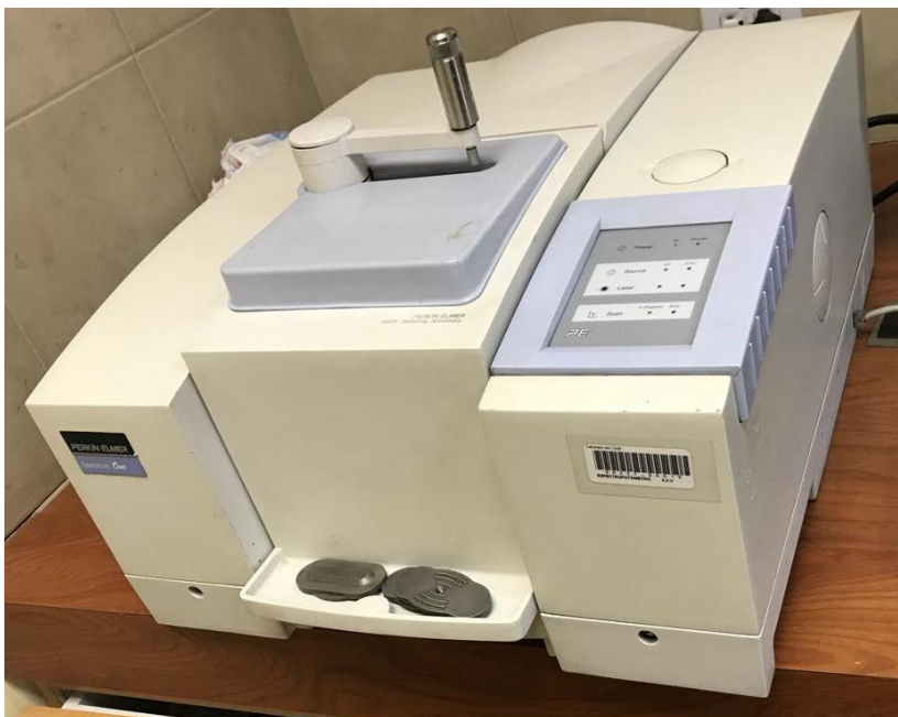
Equipo para la caracterización del producto de la depolimerización del PET mediante espectroscopia de infrarrojo con transformada de Fourier (FTIR)
