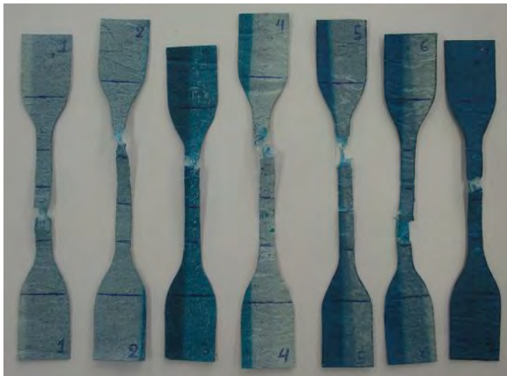
Imagen 3.4 Probetas de lámina N° 2 después del ensayo de tracción
