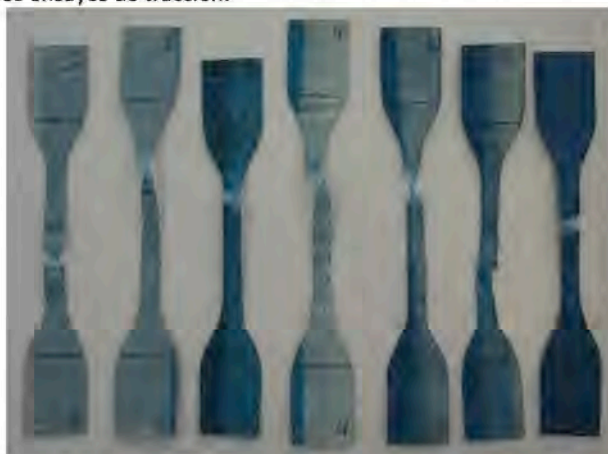
Figura 3. Probetas de lámina No. 2 (reforzadas con 8 capas) después del ensayo a tracción.
