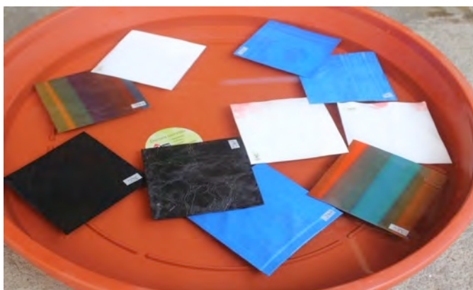
Imagen 3.7 Prueba de resistencia al agua
