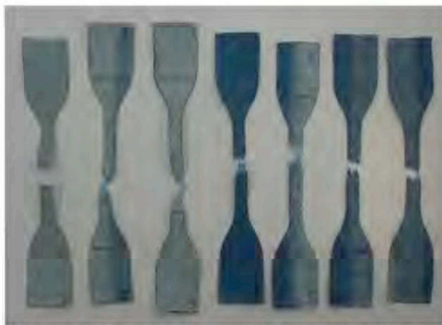
Figura 2. Probetas de lámina No. 1 (reforzadas con 4 capas) después del ensayo a tracción.
