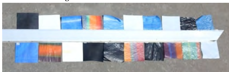
Imagen 3.9 Prueba de resistencia al sol
