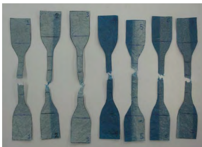
Imagen 3.3 Probetas de lámina N° 1 después del ensayo de tracción
