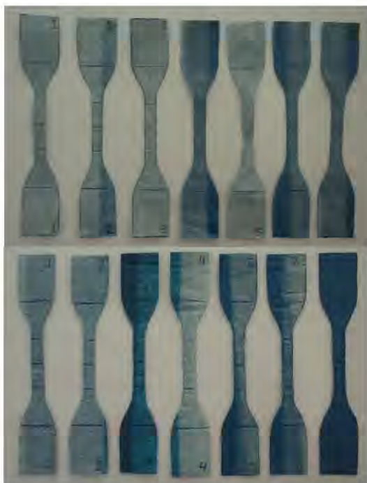
Figura 1. Probetas obtenidas de las láminas según ASTM D638-10 antes de ensayarse. (a) Lámina No. 1 y (b) Lámina No. 2.
