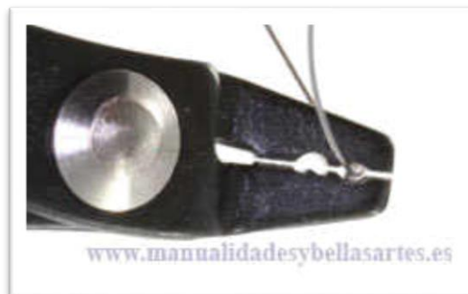
Imagen 2. 58: Aplastar una chafa con "Crimper Tool"
