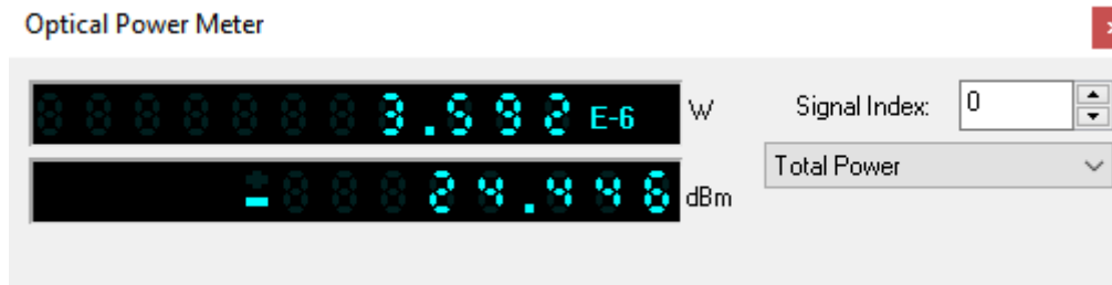
Figura 4-13 Medidor de potencia 199 km
