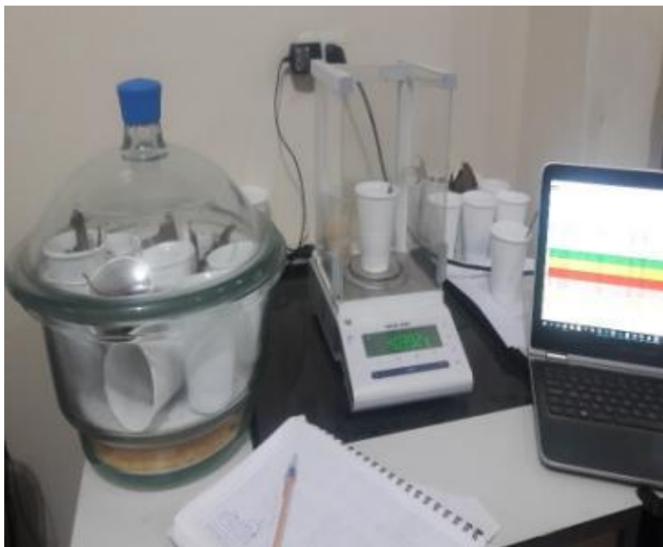
Figura 10. Balanza semi-analítica Metler Toledo MS104S, disecador, pesada de la materia orgánica e ingreso de datos obtenidos.
