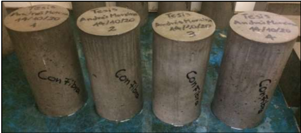
Anexo 24. Probetas cilíndricas de hormigón con fibra en la cámara de humedad.
