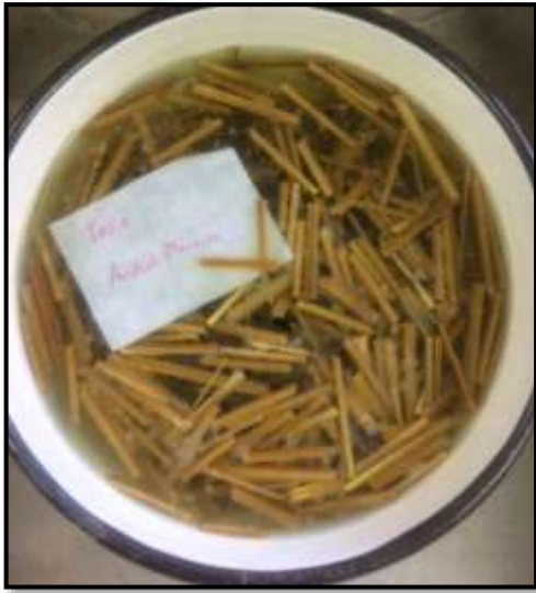
Anexo 9. Haces de fibra sumergidos en hidróxido de calcio.
