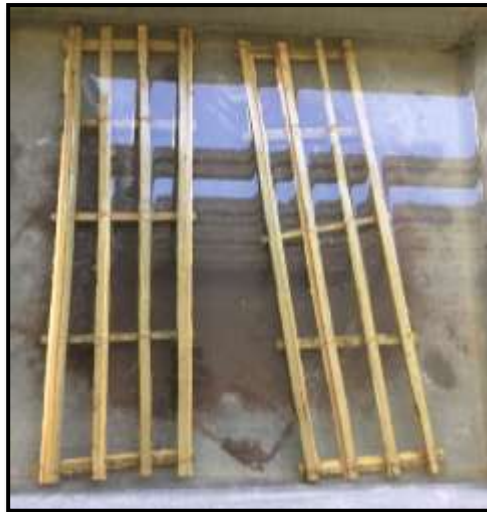
Anexo 11. Trenzados de fibra sumergidos en hidróxido de calcio.
