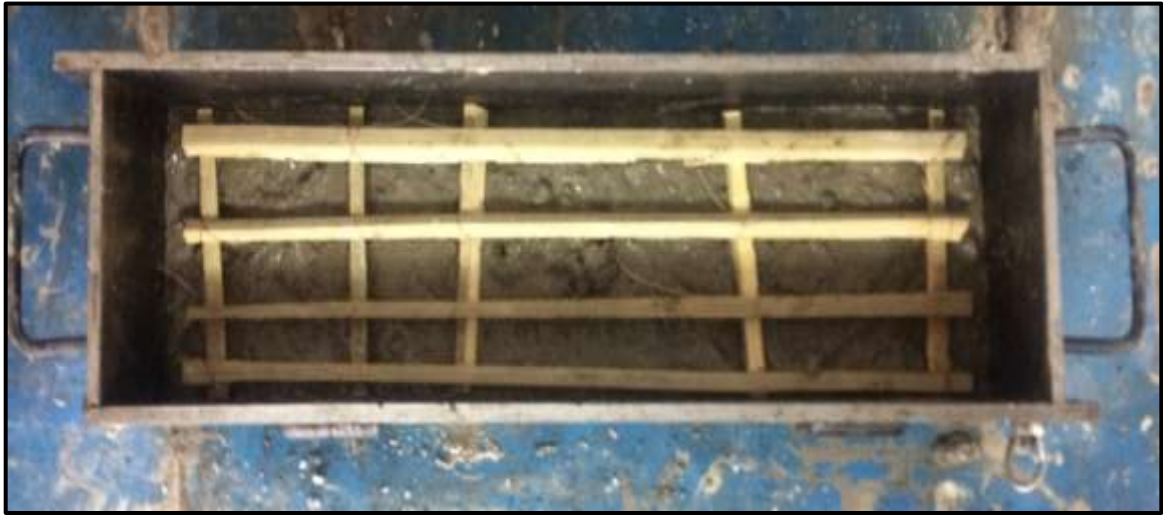
Anexo 21. Colocación del trenzado de fibras en las probetas prismáticas de hormigón.
