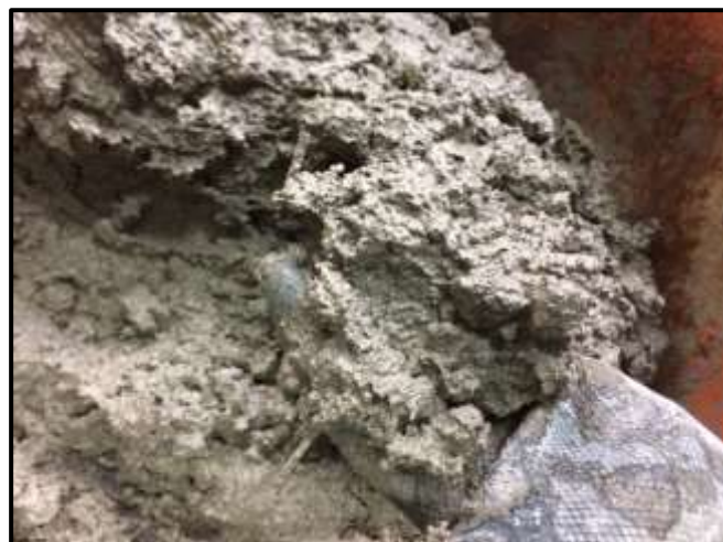
Anexo 17. Mezcla de hormigón con fibra.
