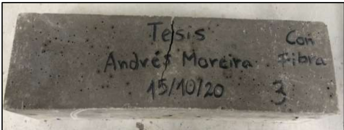
Anexo 34. Rotura a los 28 días de la probeta prismática de hormigón con el trenzado de fibras.
