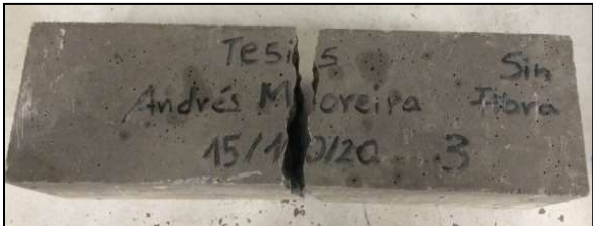
Anexo 33. Rotura a los 28 días de la probeta prismática de hormigón sin el trenzado de fibras.
