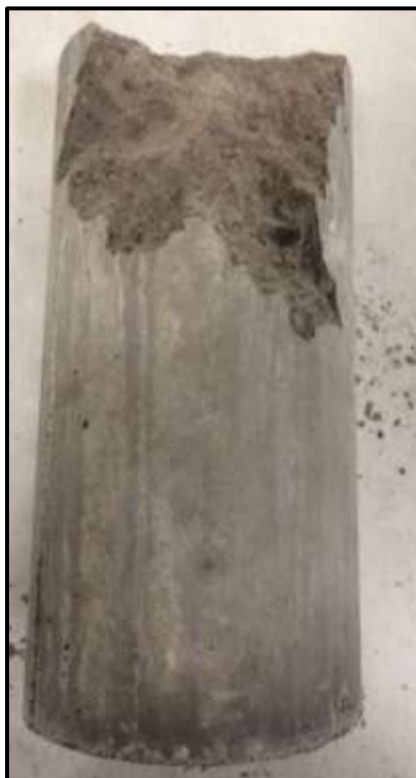
Anexo 27. Rotura a los 7 días de la probeta cilíndrica sin fibra.
