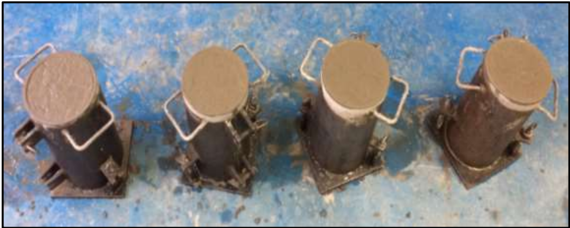
Anexo 18. Preparación de las probetas cilíndricas de hormigón sin fibra.
