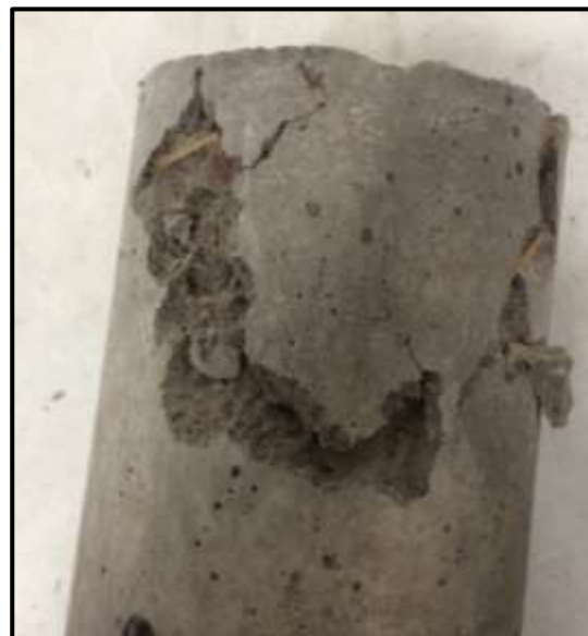
Anexo 28. Rotura a los 7 días de la probeta cilíndrica con fibra.
