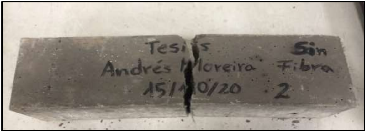
Anexo 29. Rotura a los 7 días de la probeta prismática de hormigón sin el trenzado de fibras.
