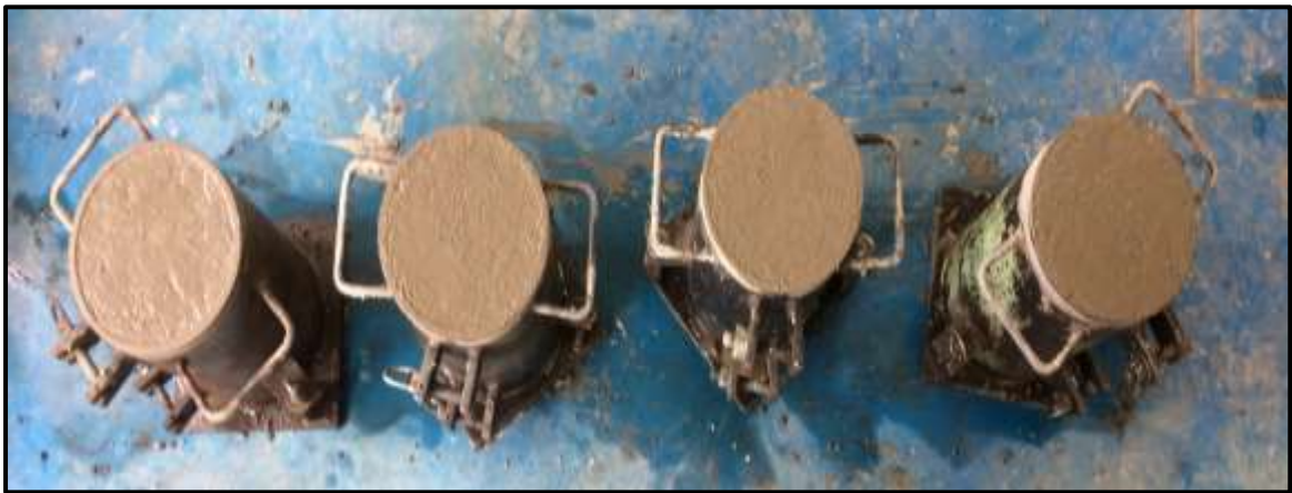
Anexo 19. Preparación de las probetas cilíndricas de hormigón con fibra.
