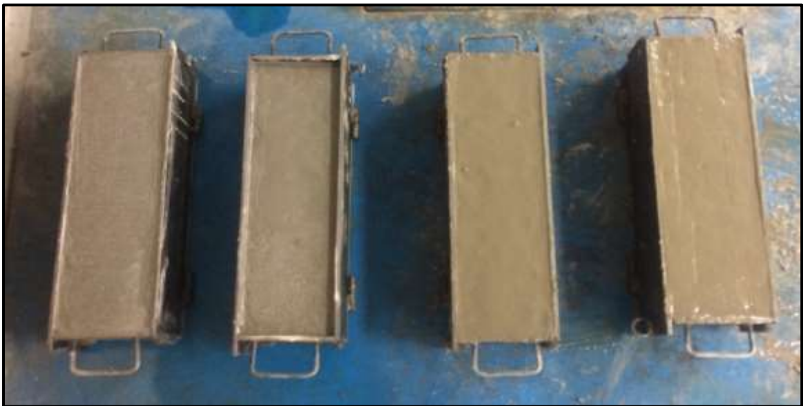
Anexo 20. Preparación de las probetas prismáticas de hormigón sin el trenzado de fibras.
