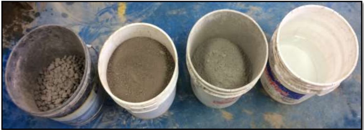
Anexo 1. Agregado grueso, fino, cemento y agua.
