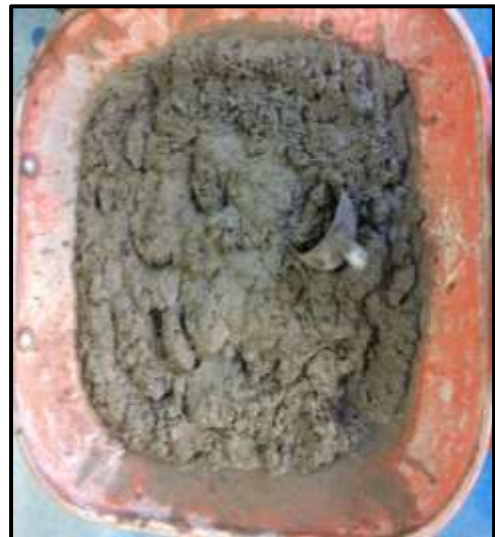
Anexo 16. Mezcla de hormigón sin fibra.
