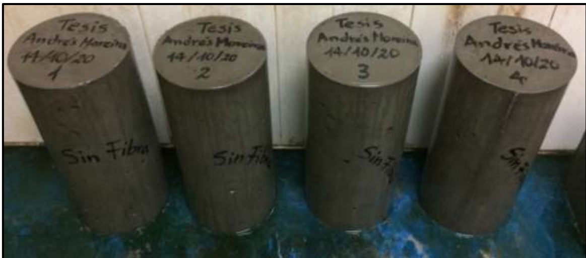
Anexo 23. Probetas cilíndricas de hormigón sin fibra en la cámara de humedad.
