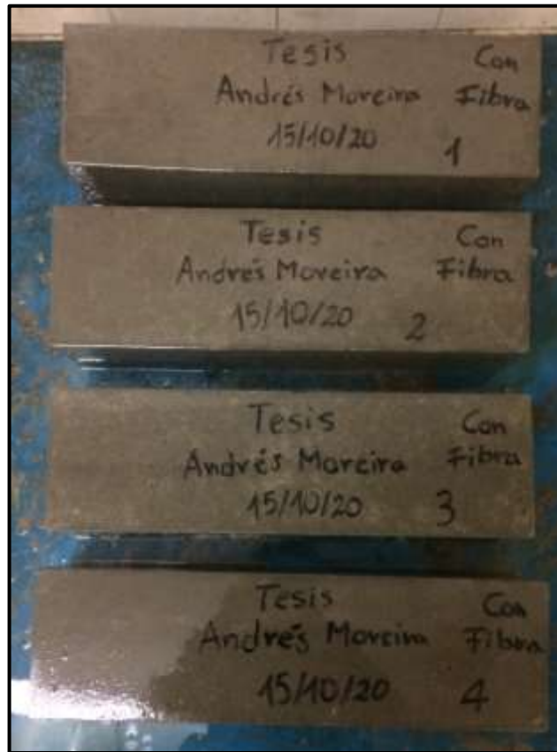
Anexo 26. Probetas prismáticas de hormigón con el trenzado de fibras en la cámara de humedad.
