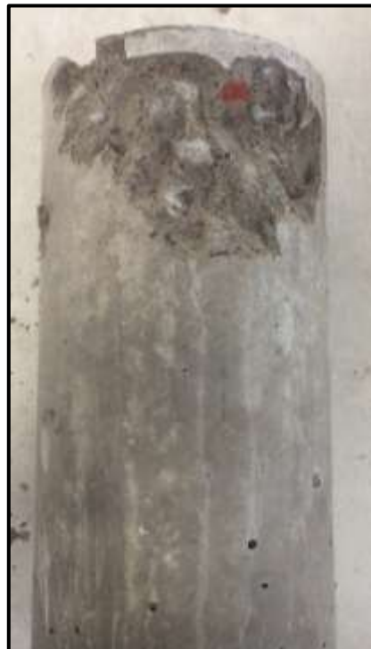
Anexo 31. Rotura a los 28 días de la probeta cilíndrica sin fibra.
