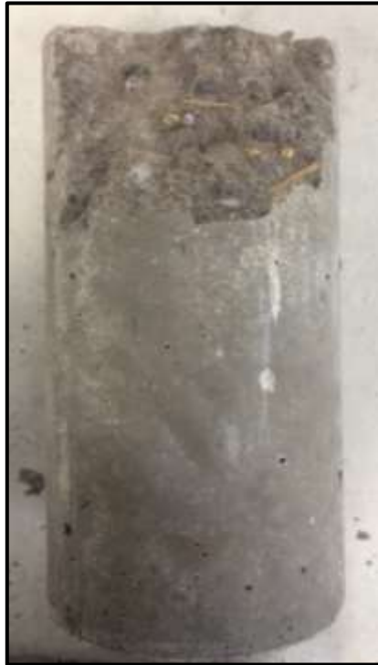
Anexo 32. Rotura a los 28 días de la probeta cilíndrica con fibra.
