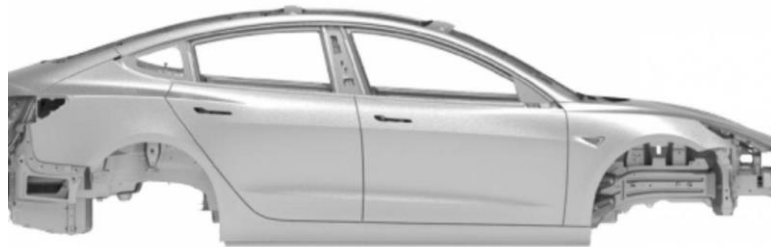
Figura 17. Carrocería con paneles terminada
