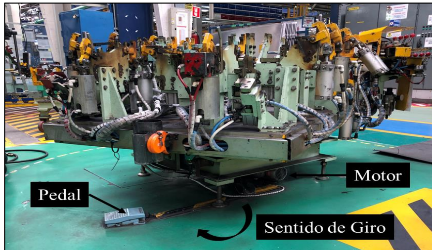
Figura 59. Sistema de giro jig estación de techos celda GV
