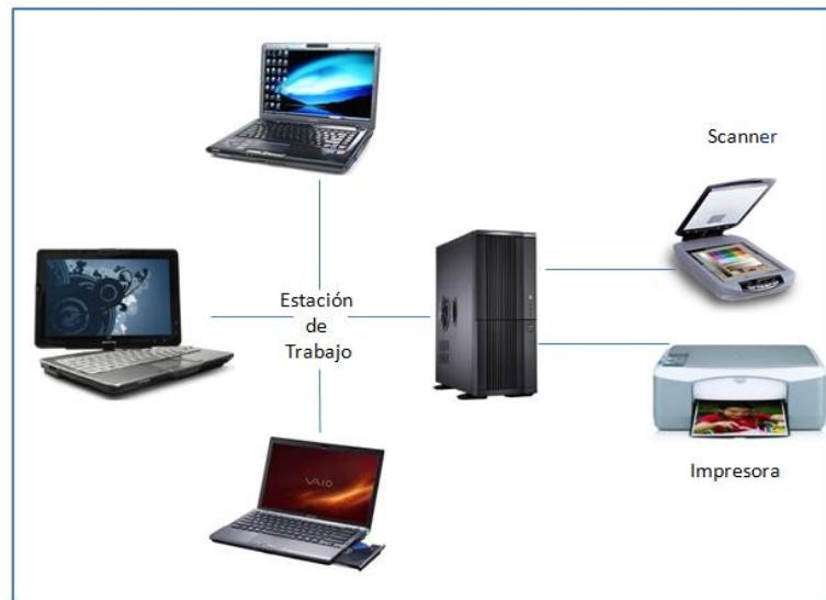
Figura 3. Red de Computadoras con estructura de cliente/servidor
