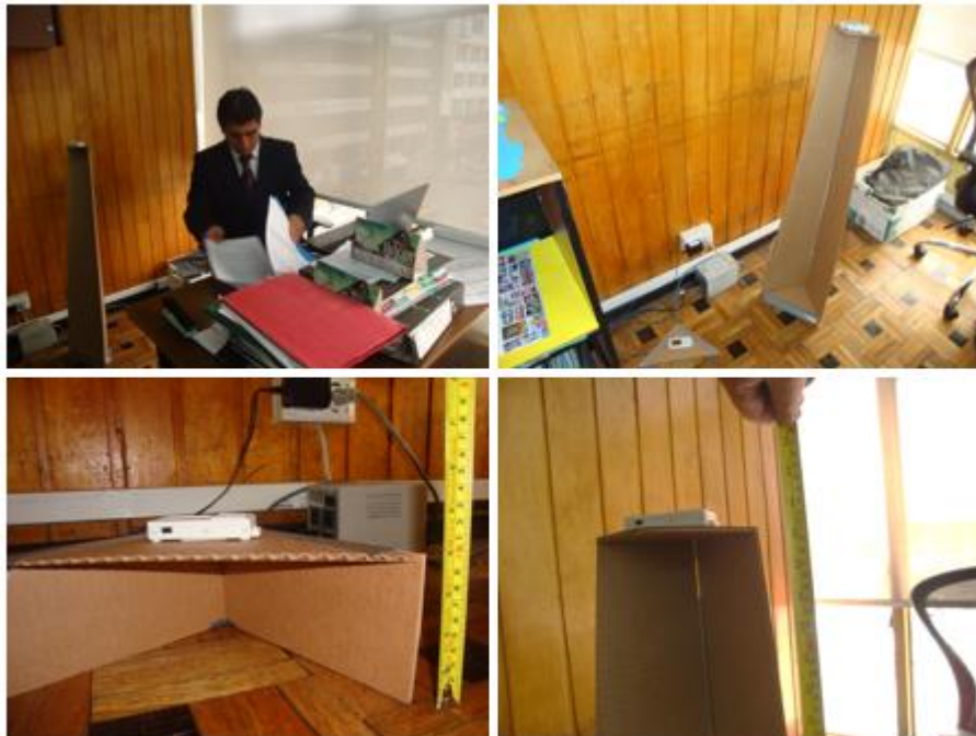
Fotografía 6. Ubicación de Loggers de la temperatura ambiente y la humedad relativa en Jefatura de Personal.
