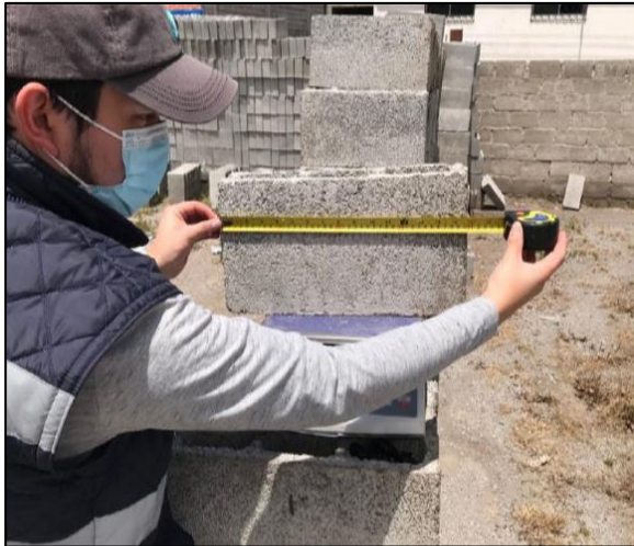
Ilustración 2 Medición de largo de bloque
