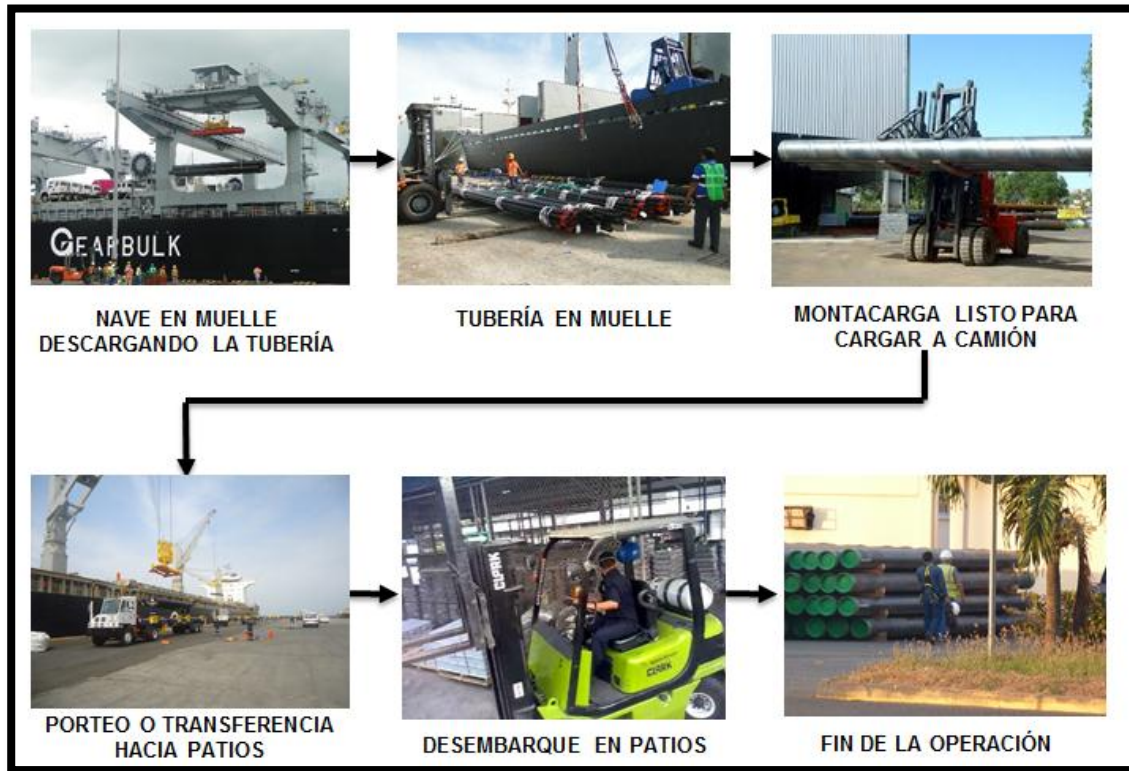
Figura 21. Circuito de una Operación de desembarque de Tubería Negra de Acero
